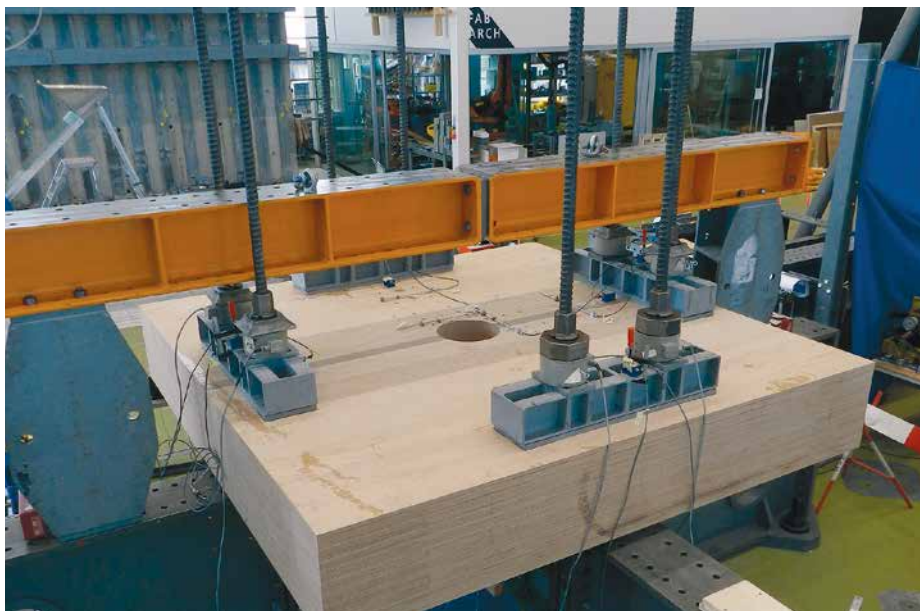
1000 Biege-, Zug- und Drucktests hat die TS3-Technik an der ETHZ im Höggerberg durchlaufen. (Foto: zvg)
