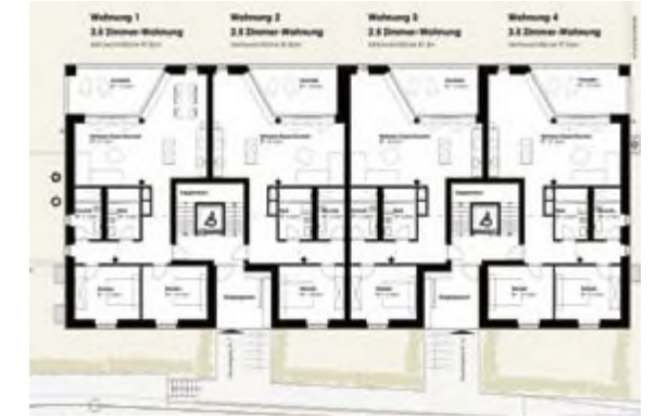
Klassischer Wohnungsbau ohne tragende Innenwände und ohne Unterzüge für volle Flexibilität
